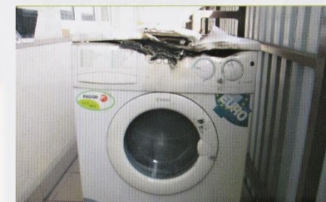
Objeďte pozornost technickému stavu elektrických spotřebičů – pračka poškozená požárem (příčina vzniku požáru netěsností bubny pračky).
