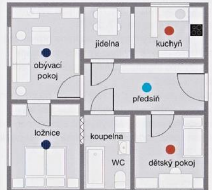
Umístění hlásičů požáru v rodinném domě o ploše do 150 m 2 .
