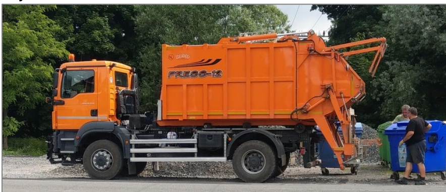
Obrázek 20.: Svozové vozidlo s nástavbou s lineárním stlačováním a pohonem všech kol – obec Trojanovice
