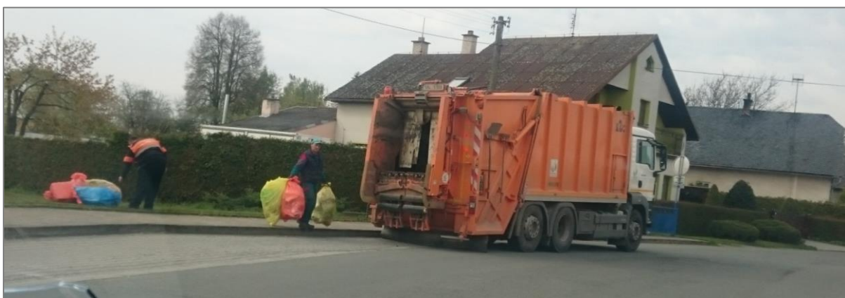
Obrázek 31.: Použití vozidla s lineárním presem pro svoz pytlů, obec Kolšov
